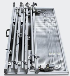
▲ Abb.: Simulationen an einem Schiebedach (Referenzierungs-Anschläge, Blockierung auf Normal-Verfahrweg)
