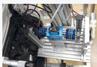
▲ Abb.: Verfahrweg-Messung an Fensterheber
