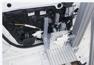
▲ Abb.: Kraft-Messung und -Beeinflussung am Fensterheber
