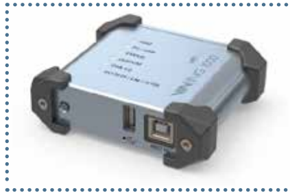
Bild 1: Kompaktes VCI für einfache Service-Diagnose. (© Softing)
